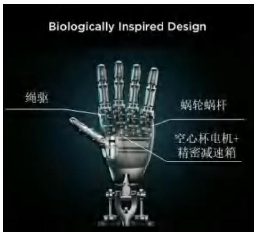
图表：特斯拉机器人手部执行器工作原理
