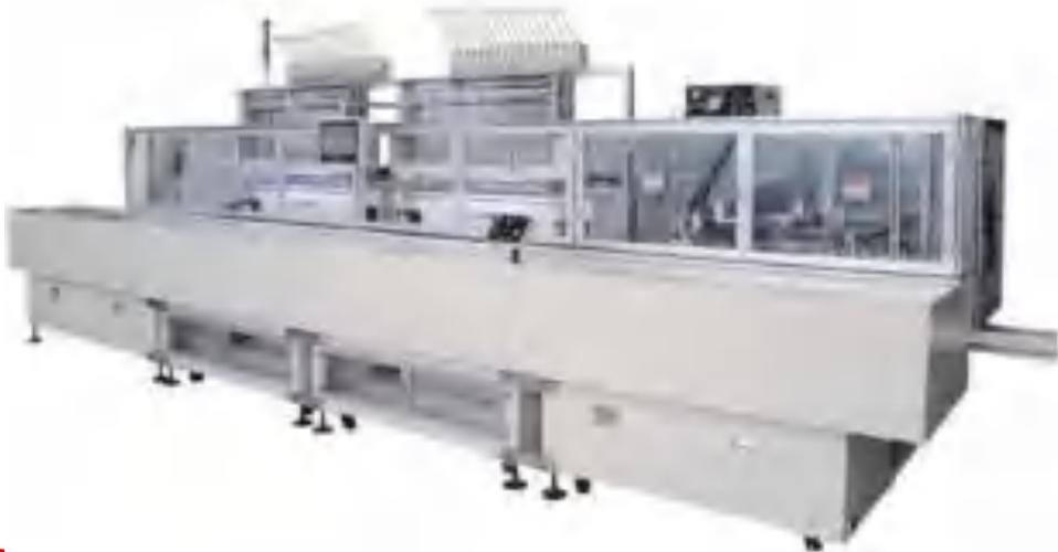
图表：日本产空心杯线圈绕线机精确机一体机
