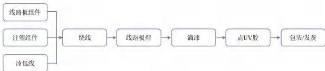
图表：空心杯（直流无槽）电机生产流程图
